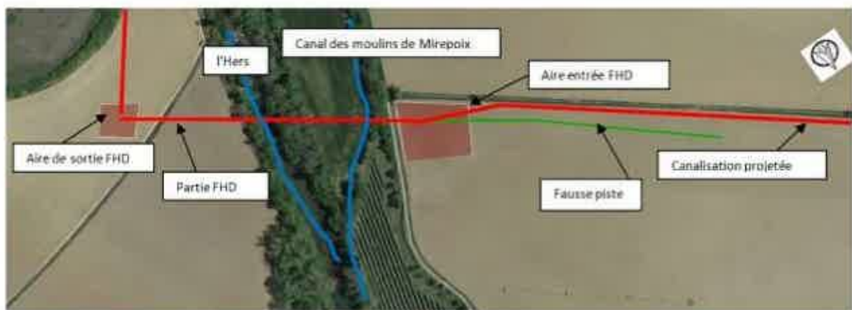
Figure 43 : Emprise du chantier du FHD de l'Hers
